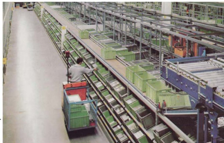
Kommissionieranlage für ein grosses Sortiment. Die Ware lagert in Durchlaufregalen. Bereitstellung der Information über Datenfunk und MDE-Terminals.
