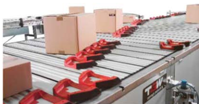
Schuhsorter. Bei dieser Sorterbauart kippt das Band nicht, dafür werden die Kartons mit Hilfe von „Kunststoffschuhen“ an der Zielstelle abgeschoben.
