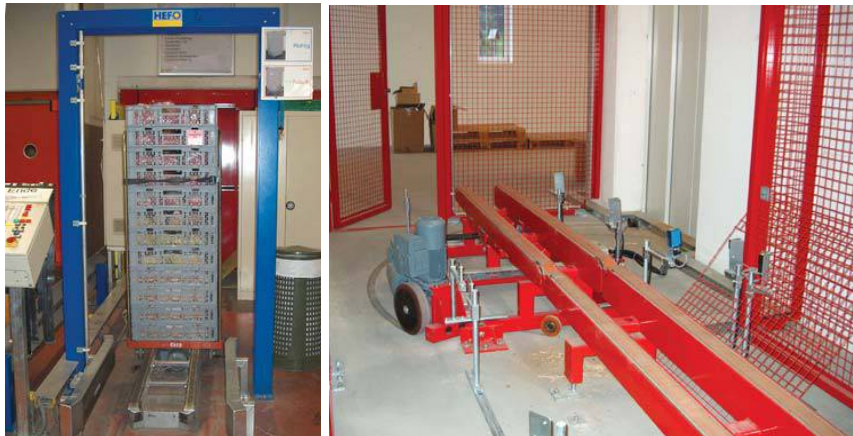
Kombi-Fördereinrichtung. Auf dem Bild rechts ist in der Mitte die Dreheinrichtung gut zu sehen.
