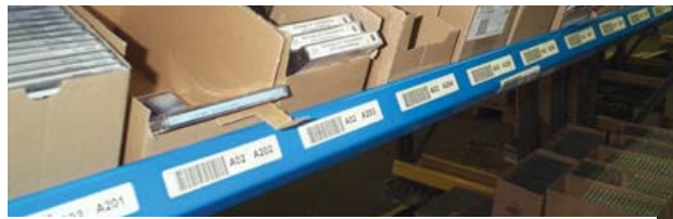
Durchlaufregale gewährleisten FIFO.
