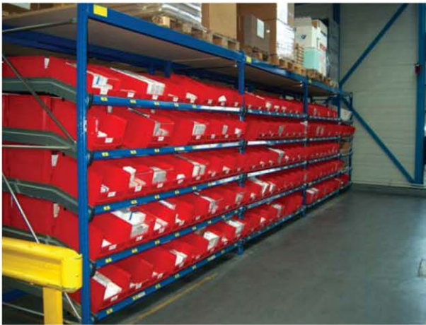
Die Kommissionierung aus einem Durchlaufregal verkürzt die Kommissionierwege. Durchlaufregale eignen sich besonders für Artikel mit vielen Zugriffen. Neben der Verkürzung der Kommissionierwege ist die Trennung der Kommissionierung von der Einlagerung ein weiterer Vorteil. Es entstehen auf diese Weise weniger Behinderungen.
