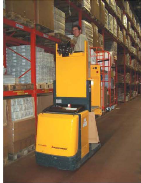
Das Kommissionierfahrzeug ist mit einem Hub von ca 1.2 m ausgerüstet. Damit ist auch die zweite Palettenebene im Zugriff für die Kommissionierer.
