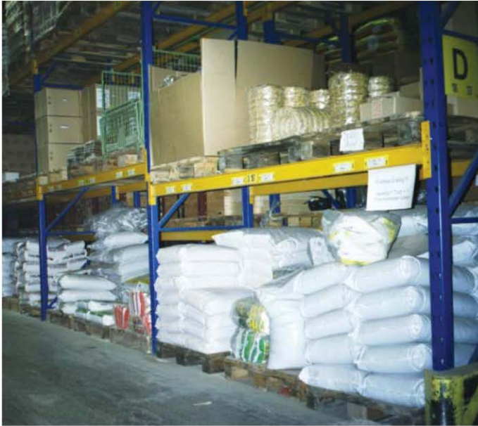
Konventionelles Nonfood-Kommissionierlager. Die Kommissionierplätze befinden sich auf dem Hallenboden, die Reservepaletten sind darüber gelagert.
