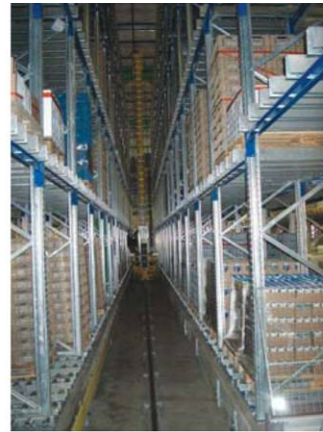
Regalgasse mit automatischem Regalbediengerät
