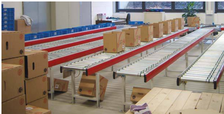
Staubahnen für leere Kartons als Puffer für die Kommissionierung nach dem Pick-pack – Prinzip (kommissionieren direkt in den Versandkarton).
