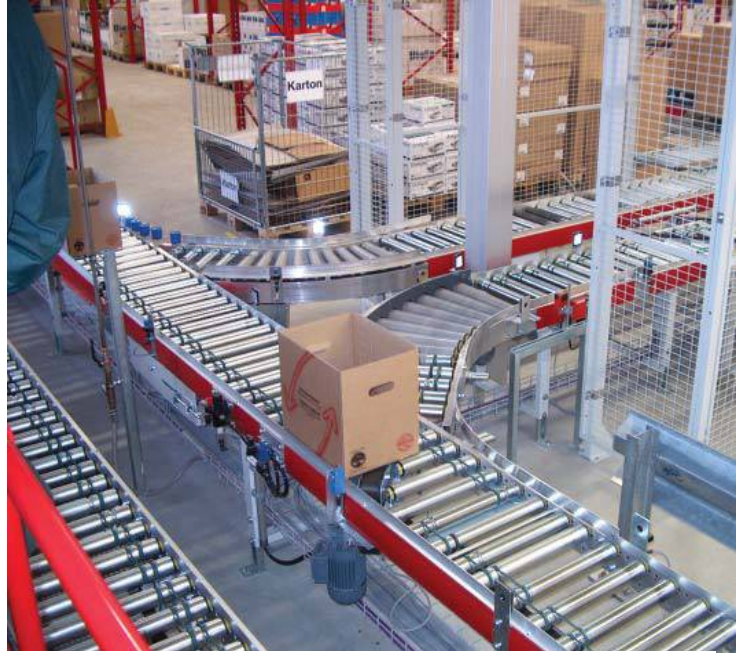
Ausschleusung in eine Kommissionierzone. Die Kommissionierzonen sind mit Fachbodenregalen, Durchlaufregalen und Palettenregalen ausgestattet.
